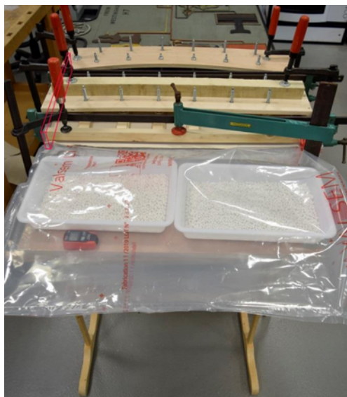
Fig. 6 : dispositif de remise à plat avec retrait contrôlé ( compression set ) sur l'objet d'étude, d'après (Sim2022)
