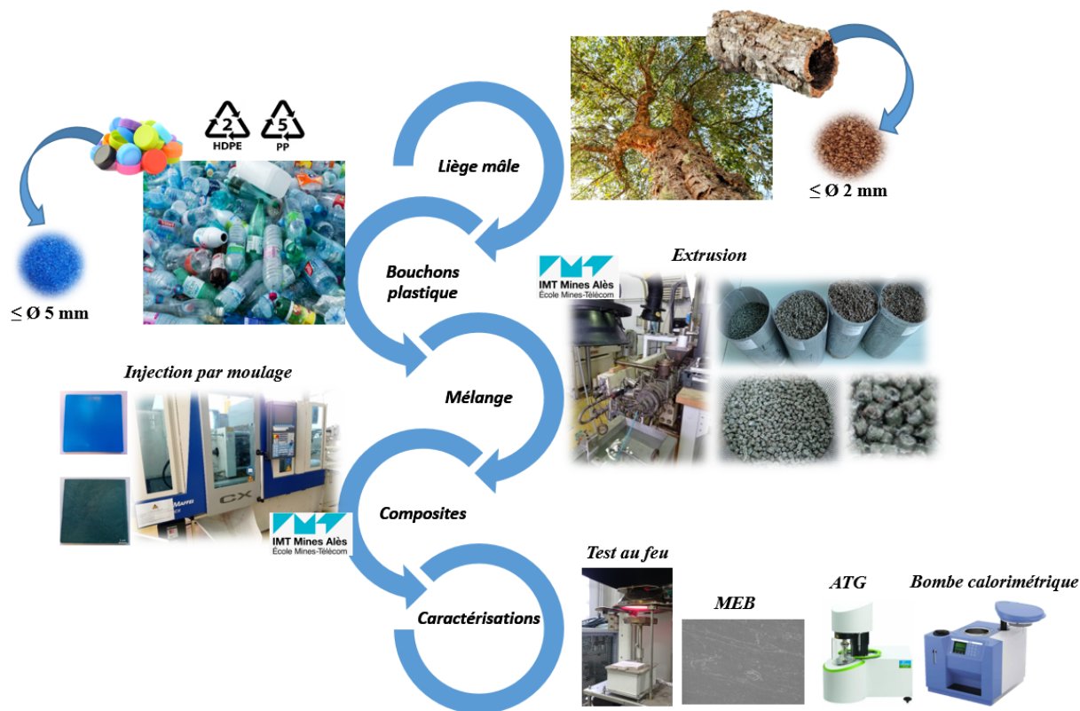
Fig. 1. Schéma d'élaboration des composites à base de polymères recyclés et de liège
