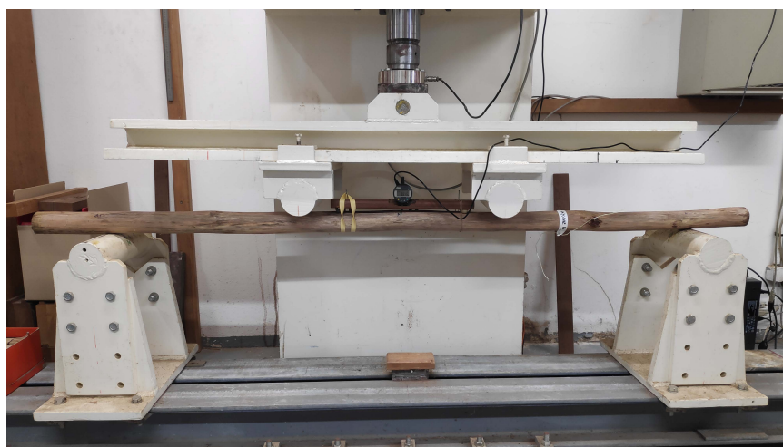
Fig. 1 : Essai de flexion quatre points sur une perche de 2,20m de long et de 8cm de diamètre.
