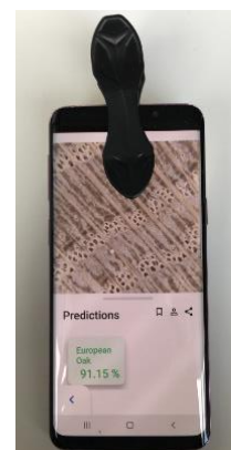
Fig. 2 : Samsung galaxy S9 avec macro objectif et application Xylorix
