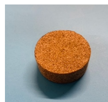
Fig. 3 : Eprouvette pour la mesure des caractéristiques physiques et la dureté
