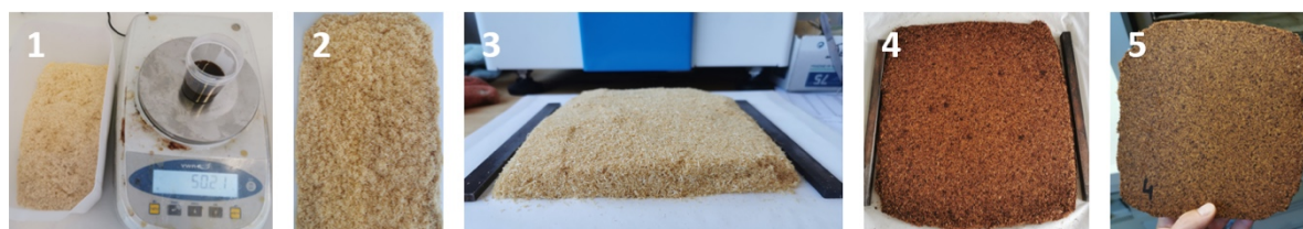
Fig. 1 : Etapes de fabrication des panneaux. 1 : sciure et résine, 2 : sciure imprégnée de résine, 3 : préparation du mat, 4 : panneau après pressage, 5 : panneau après stabilisation
