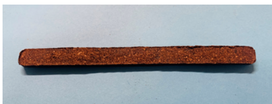
Fig. 2 : Eprouvette pour la flexion 3 points
