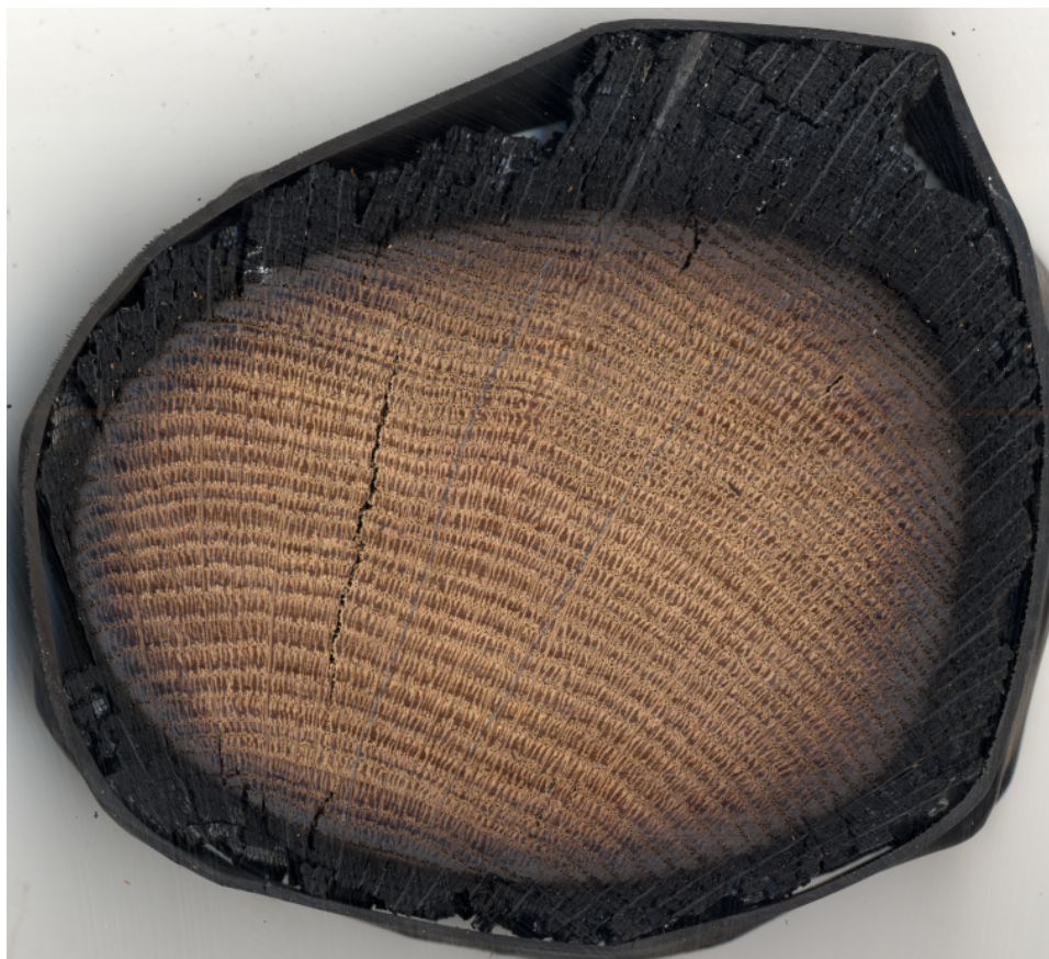
Fig. 3 : Tranche sciée dans un reste carbonisé de la nef (VN8-D1) pour l'analyse des largeurs de cernes. Une gaine thermo-rétractable consolide la périphérie carbonisée (B. Brossier). Le cerne le plus ancien date de 1111 le plus récent de 1175 (A. Dufraise et O. Girardclos).
